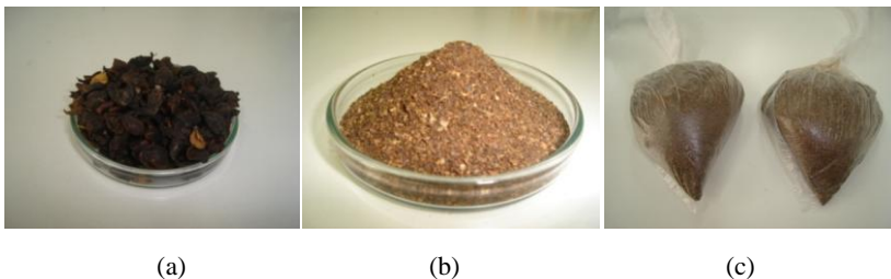
Figura 5: (a) casca de café in natura ; (b) moída; (c) acondicionada em embalagem plástica.
