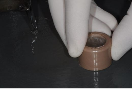
Figura 6- Padronização da superfície cerâmica com lixas SiC #600
