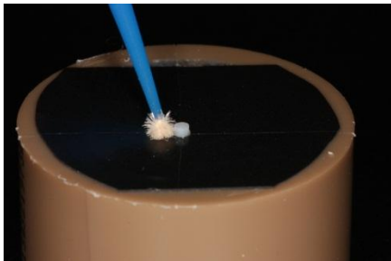
Figura 19- Remoção dos excessos de cimento resinoso com um pincel descartável
