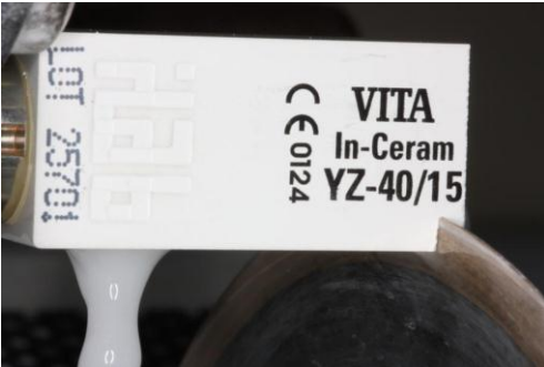
Figura 1- Corte dos blocos cerâmicos pré-sinterizados
