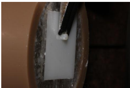
Figura 24- Realização do teste de microcisalhamento vista lateral
