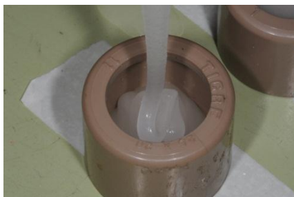
Figura 5- Inclusão das pastilhas cerâmicas em resina acrílica. A fita dupla face foi utilizada como fixação da pastilha cerâmica
