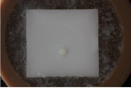
Figura 21- Delimitação adesiva removida, visualizando o corpo de prova cimentado, sem excessos marginais
