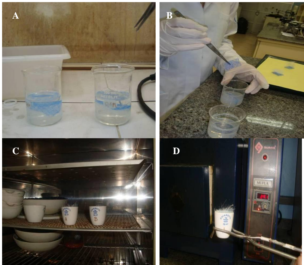
Figura 19: Etapas do Método 1: A) Filtros imersos na solução \text{TiO}_2 ; B) Filtros retirados da solução após 30 minutos; C) Filtros secos na estufa, a 105°C, por 1 hora; D) Filtros calcinados na mufla, a 500 °C, por 4 horas.
