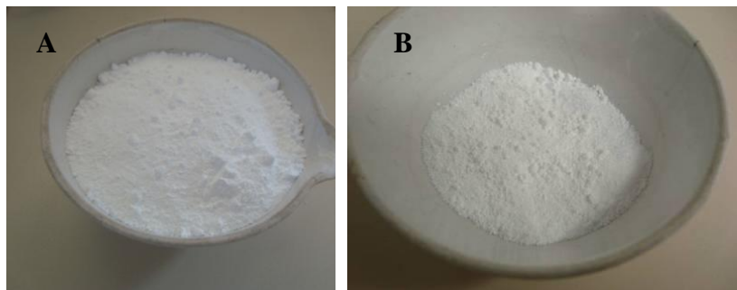
Figura 27: Amostras do pó de \text{TiO}_2 – P25: A) antes do tratamento térmico; B) Após tratamento térmico.
