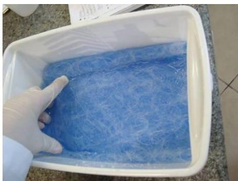
Figura 21: Limpeza da fibra com solução de HCl e NaOH, antes da deposição de TiO 2 comercial - P25– Degussa.
