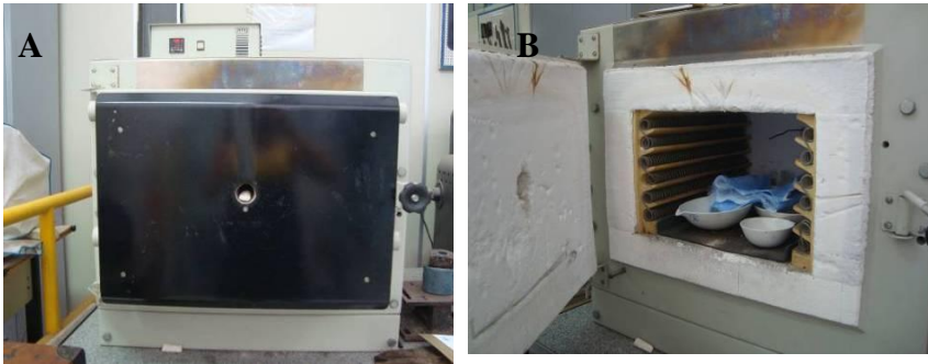
Figura 29: Forno utilizado para tratamento térmico nas amostras de filtro maiores: A) Forno fechado; B) Forno aberto.
