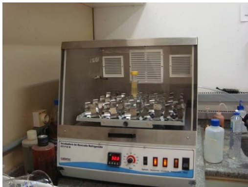
Figura 47: Agitação da suspensão de bactérias a 85 rpm e 37°C.
