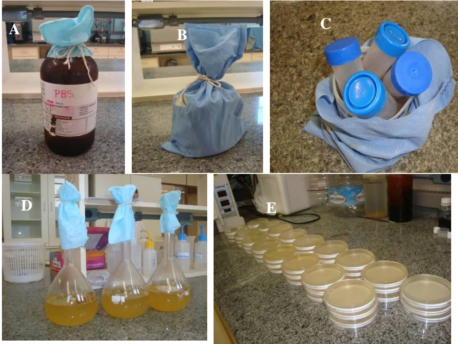
Figura 44: Materiais esterilizados: A) Solução de PBS; B) e C) Tubos com caldos (CTS); D) Solução com Ágar (ATS) e E) Ágar distribuído nas placas de Petry.
