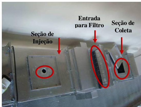
Figura 43: Vista da parte superior do duto, com destaque para a seção de injeção, suporte para entrada do filtro e seção de coleta. Todas se apresentam abertas para facilitar a evaporação do desinfetante no interior do duto.
