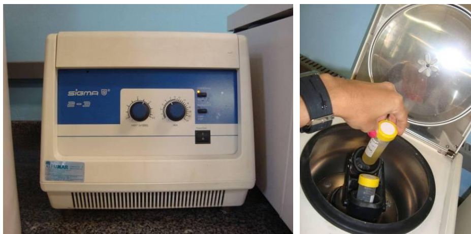
Figura 48: Centrifugação da amostra a uma velocidade de 2500 rpm por 5 minutos.
