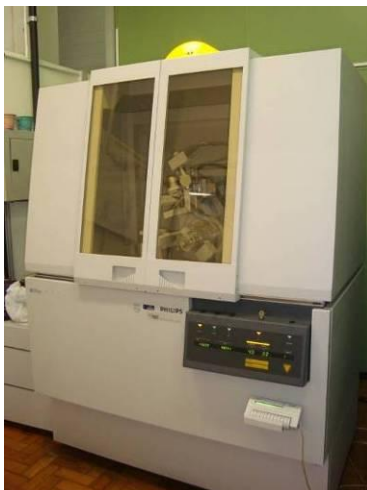
Figura 25: Difratorômetro de raios-X utilizado para avaliação das amostras.
