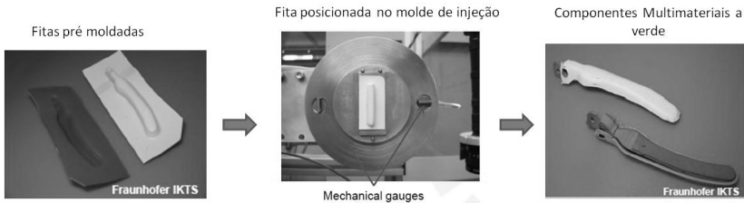
Figura 6 – Etapas do processo de In-mold Labeling (BAUMANN et al., 2009).
