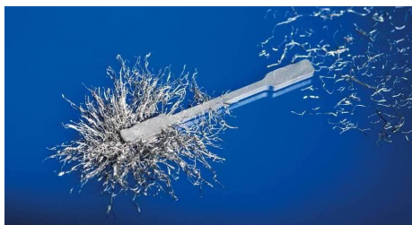
Figura 7 – Corpo de prova magnético / não magnético (Cortesia: Fraunhofer IFAM – Bremen).
