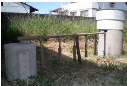
Figura 6: Amostrador utilizado na pesquisa de Hagemann.
