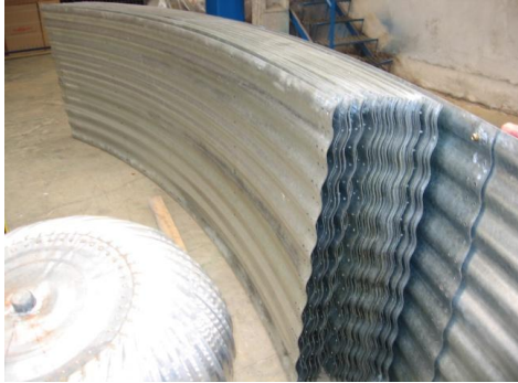
Figura 23: Chapas de aço galvanizado corrugadas e calandradas.
