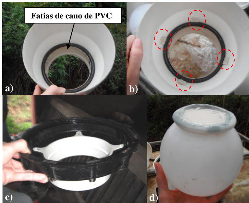
Figura 30: a) anel de borracha e “fatias” de cano de PVC; b) ressaltos de PVC; c) vedação da tampa da bombona; d) bóia.
