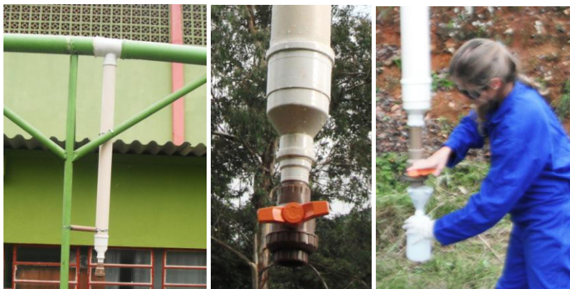
Figura 44: Amostrador para coleta da água da chuva após passagem pela área de captação.
