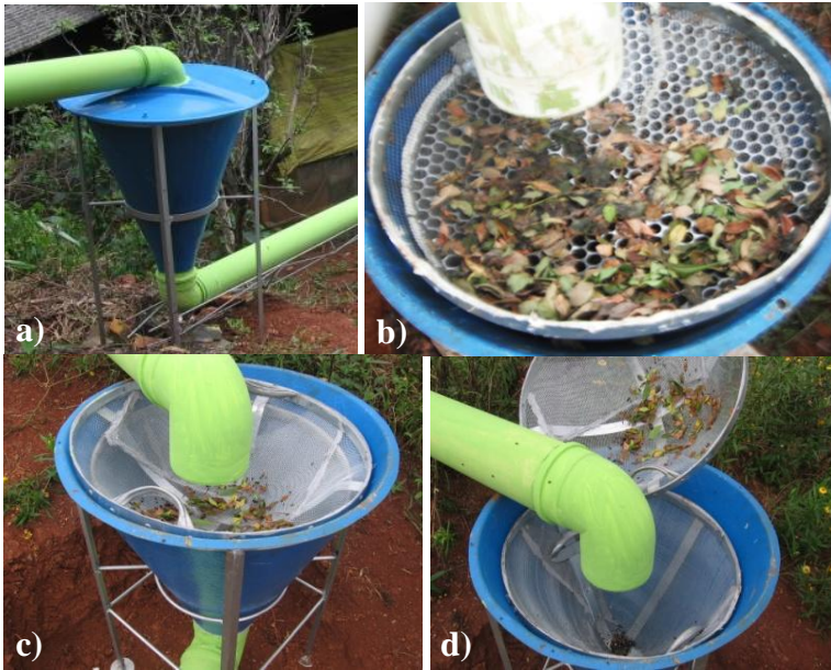
Figura 24: a) Funil Coador; b) peneira superior; c) peneira intermediária; d) peneira inferior.
