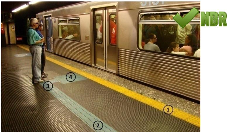
Figura 40 - Exemplo de aplicação das quatro funções dos pisos táteis, conforme a NBR 9050/2004, na Estação da Sé do Metrô da cidade de São Paulo (SP).
