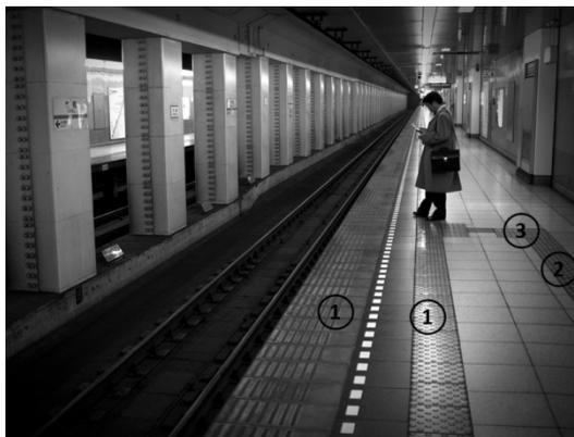
Figura 28 – Diferentes tipos de pisos táteis funcionando como um sistema de orientação, em Estação de Metrô (Japão)
