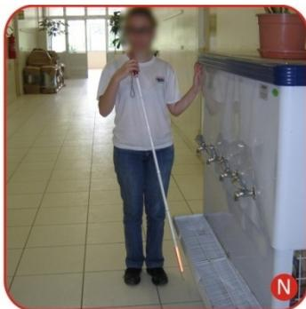
Figura 86 - Ponto N na Figura 87 - Corredor de salas de aula do Bloco A - Bebedor é obstáculo para aluna cega
