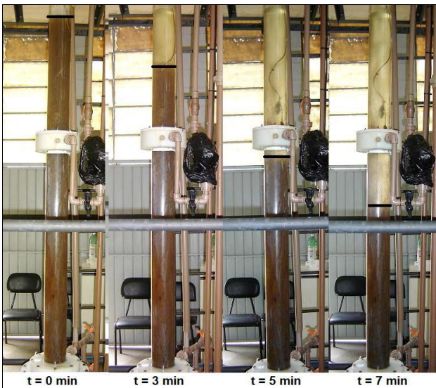
Figura 62. Sedimentação do lodo ao longo da fase de sedimentação aos 53 dias de operação ( T_s = 7 min).
