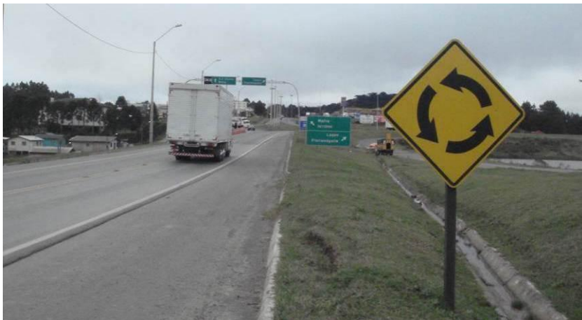
Figura 67 Sinalização de advertência A-12 - interseção em círculo (BR116)
