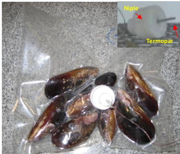
**Figura 4.6.** Embalagem flexível termoprocessável contendo mexilhões e termopar acoplado através do “niple”. Em destaque, o tubo de inox contendo o termopar e inserido no “niple”.
