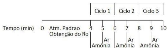
Figura 5.6 - Análise de determinação do  $R_0$  e os ciclos de ativação do material
