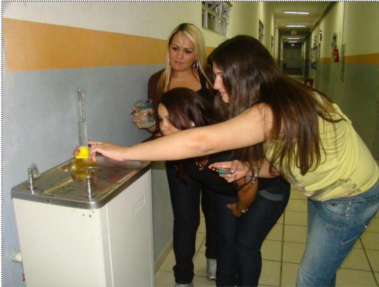
**Figura 11:** Medição de volume de água escoada num intervalo de tempo
