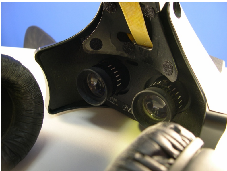
Figura 4: sistema óptico para focar os LCDs do VFX1 Fonte: foto do autor
