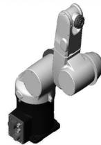
**Figura 2.10:** Redundância de posicionamento direita-esquerda.
