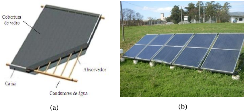
Figura 10: (a) Esquema da tubulação no coletor solar; (b) coletores solares implantados na área experimental.
