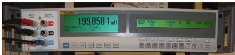
Figura 93 - Voltímetro utilizado no ensaio da placa de aquisição.
