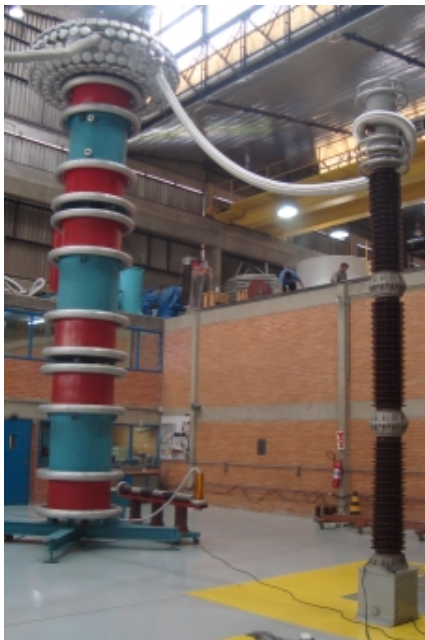
Figura 115 - Montagem do MPC para ensaio de tensão induzida.
