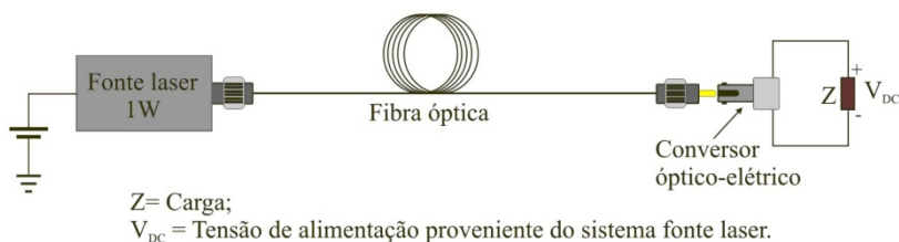
Figura 28 - Configuração do sistema Power Over Fiber - POF .
