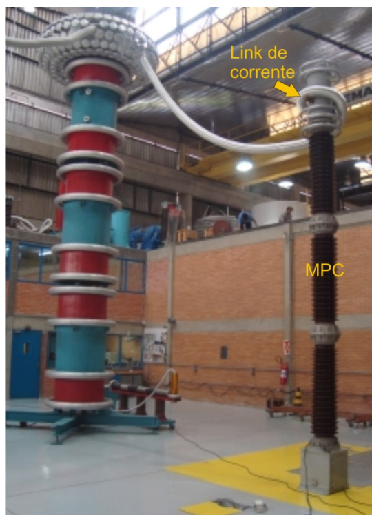
Figura 9 - MPC sob ensaio de tensão.
