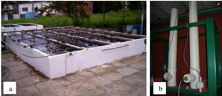
Figura 7 Exemplos de tanques (a) e torres (b) de air stripping . Fontes: Leite (2009); LaGrega et al. , (2001 apud SOUTO, 2009).
