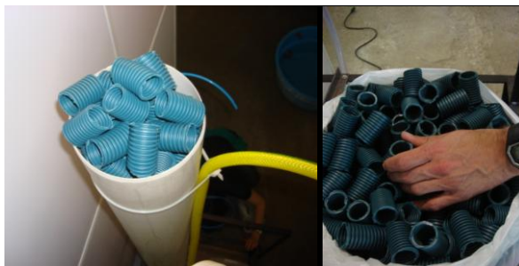
Figura 16 Anéis tipo “raschig” usados para recheiar a torre de air stripping .
