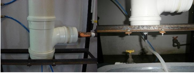
Figura 21 Mudança no diâmetro da mangueira de saída do lixiviado da torre para o recipiente de armazenamento.
