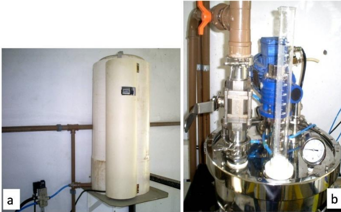
Figura 12 Instrumentos utilizados para medição quantitativa do biogás produzido: gasômetro (a) e o bolhômetro (b).
