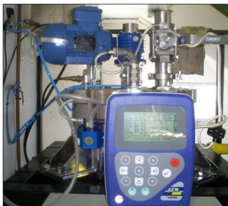
Figura 16 Aparelho GEM2000 usado na medição qualitativa do biogás.
