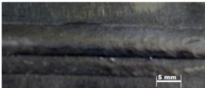
Figura 5.64 – Solda de topo da calha-tubo material API 5L X70 e metal de adição AWS E 71T-11 no processo FCAW-S. O tubo contém água como fluido interno na vazão de 80 l/min. e pressão de 2 bar.
