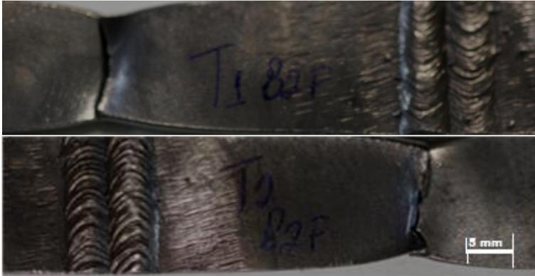
Figura 5.66 – Corpos de prova dos ensaios de material API 5L X70 e metal de adição AWS E 71T-11 no processo FCAW-S. O tubo contém água como fluido interno na vazão de 80 l/min. e pressão de 2 bar.
