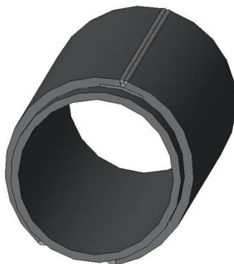
Figura 4.8 – Detalhes da solda de topo com chanfro em V com três cordões (calha com tubo).
