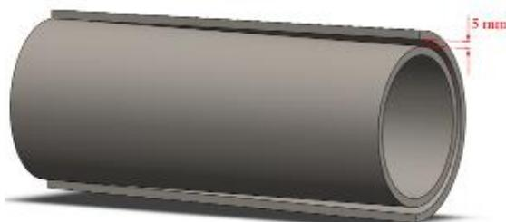
Figura 4.2 – Desenho mostrado a folga de 0 a 5,0 mm entre a calha e o tubo.
