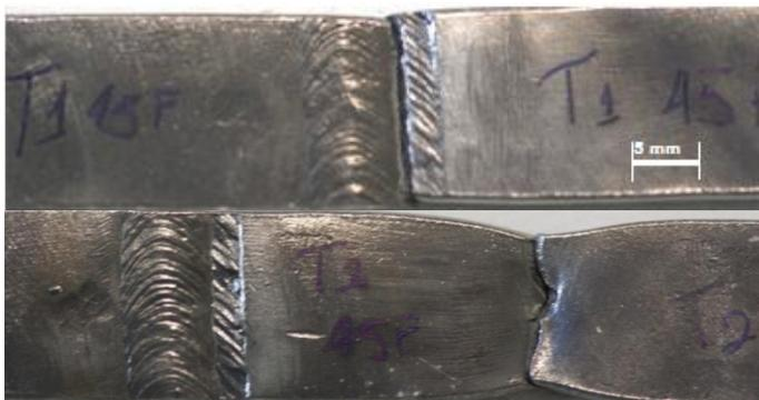
Figura 5.75 – Corpos de prova dos ensaios de tração material API 5L X70 e metal de adição AWS E 71T-11 no processo FCAW-S. O tubo contém água como fluido interno na vazão de 40 l/min. e pressão de 5 bar.
