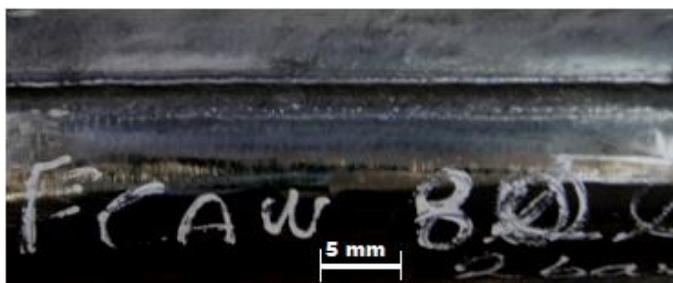
Figura 5.65 – Solda de filete da calha-tubo material API 5L X70 e metal de adição AWS E 71T-11 no processo FCAW-S. O tubo contém água como fluido interno na vazão de 80 l/min. e pressão de 2 bar.
