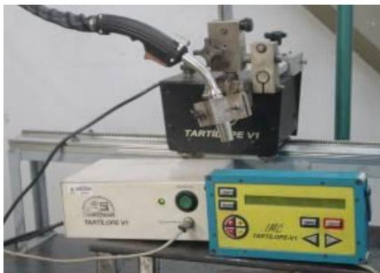
Figura 4.17 - Sistema de deslocamento da tocha.
