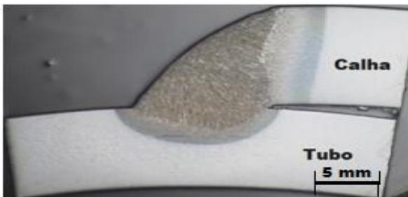
Figura 5.80 - Macrografia da calha-tubo material API 5L X70 e metal de adição AWS E 71T-11 no processo FCAW-S. O tubo contém água como fluido interno na vazão de 40 l/min. e pressão de 5 bar.
