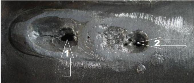
Figura 5.32 – Furos provenientes da soldagem de tubo com fluido e pressão interna: Seta 1 devido ao esforço trativo; Seta 2 devido a incidência do arco voltaico.
