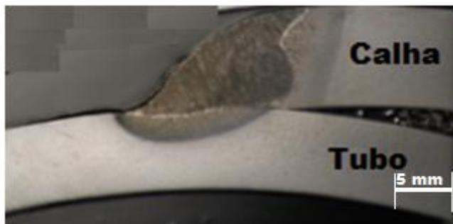
Figura 5.62- Macrografia da calha-tubo material API 5L X70 e metal de adição AWS ER 80S-G no processo GMAW-P. O tubo contém água como fluido interno na vazão de 40 l/min. e pressão de 5 bar.
