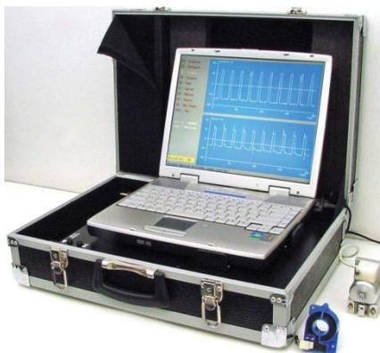
Figura 4.18- Sistema de aquisição portátil de dados de soldagem (SAP).
