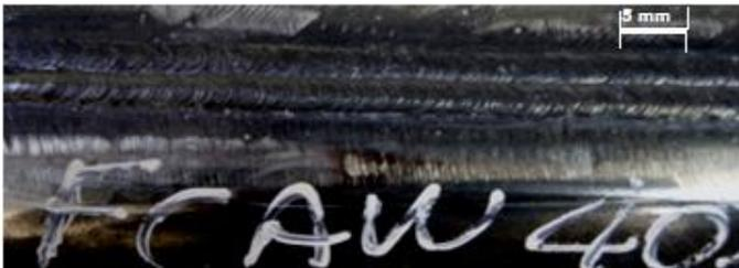
Figura 5.73 – Solda de topo calha-tubo material API 5L X70 e metal de adição AWS E 71T-11 no processo FCAW-S. O tubo contém água como fluido interno na vazão de 40 l/min. e pressão de 5 bar.
