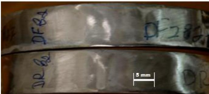
Figura 5.67 - Corpos de prova dos ensaios de dobramento de face e de raiz material API 5L X70 e metal de adição AWS E 71T-11 no processo FCAW-S. O tubo contém água como fluido interno na vazão de 80 l/min. e pressão de 2 bar.
