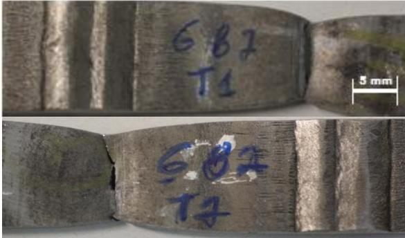
Figura 5.50 – Corpos de prova dos ensaios de tração material API 5L X70 e metal de adição AWS ER 80S-G no processo GMAW-P. O tubo contém água como fluido interno na vazão de 80 l/min. e pressão de 2 bar.
