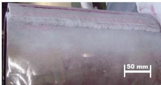
Figura 5.2 - Ensaio com líquido penetrante para a detecção de trinca superficial na união do calha/tubo: metal de base ASTM A 335 Grau P5 e metal de solda E 8018 – B8.
