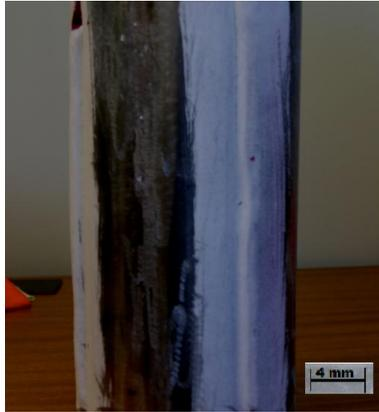
Figura 5.6 – Foto do ensaio com líquido penetrante para a detecção de trinca superficial na soldagem da calha/tubo com restrição no metal de base API 5L (X70) e metal de adição (ER 80S-G).
