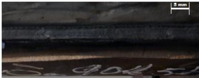
Figura 5.74 – Solda de filete calha-tubo material API 5L X70 e metal de adição AWS E 71T-11 no processo FCAW-S. O tubo contém água como fluido interno na vazão de 40 l/min. e pressão de 5 bar.
