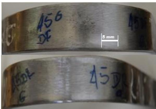
Figura 5.59 - Corpos de prova dos ensaios de dobramento de face e raiz material API 5L X70 e metal de adição AWS ER 80S-G no processo GMAW-P. O tubo contém água como fluido interno na vazão de 40 l/min. e pressão de 5 bar.
