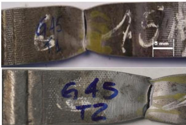
Figura 5.58 - Corpos de prova dos ensaios de tração material API 5L X70 e metal de adição AWS ER 80S-G no processo GMAW-P. O tubo contém água como fluido interno na vazão de 40 l/min. e pressão de 5 bar.
