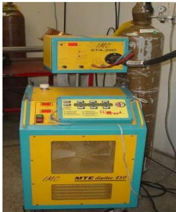
Figura 4.16 - Fonte de soldagem DIGITEC 450.
