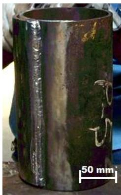
Figura 5.1 - Junta de filete com eletrodo revestido na união calha/tubo: metal de base ASTM A 335 Grau P5 e metal de solda E 8018 – B8.
