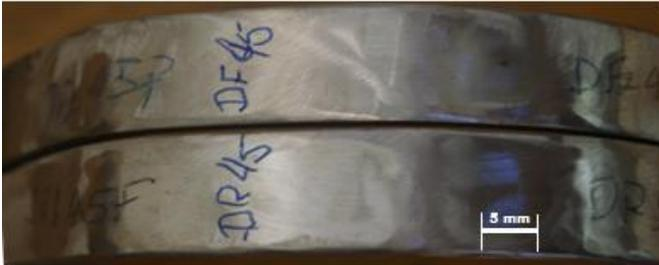
Figura 5.76 - Corpos de prova dos ensaios de dobramento de face e de raiz material API 5L X70 e metal de adição AWS E 71T-11 no processo FCAW-S. O tubo contém água como fluido interno na vazão de 40 l/min. e pressão de 5 bar.
