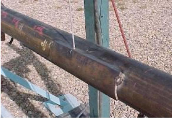
Figura 3.7 – Solda de filete entre tubo e calha (BRUCE, 2000b).
