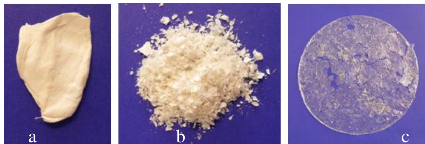
Figura 3.21 a) celulose bacteriana liofilizada, b) celulose bacteriana liofilizada e moída e c) filme de celulose bacteriana liofilizada.
