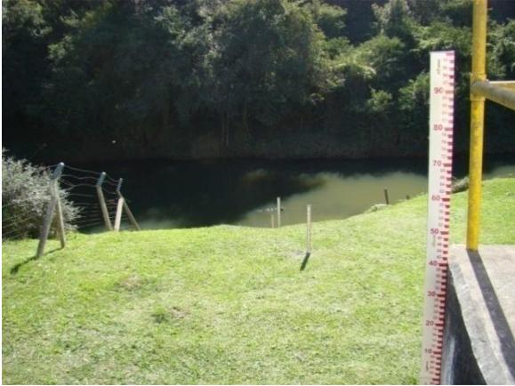
Figura 5.3 – Estação hidrossedimentológica
