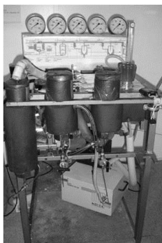
Figura 3.1 Foto do equipamento de ESC utilizado nos experimentos
