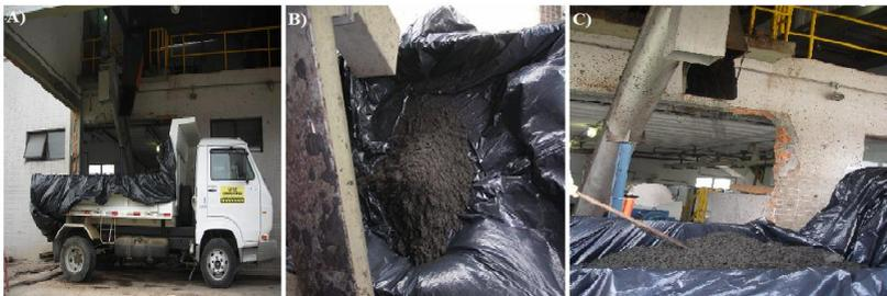
Figura 6. Coleta de lodo de esgoto *in natura*. A) Vista geral – saída do sistema de desidratação de lodo e caminhão caçamba; B) Vista superior – caçamba do caminhão; C) Vista lateral – caçamba do caminhão e saída do sistema de desidratação de lodo.
