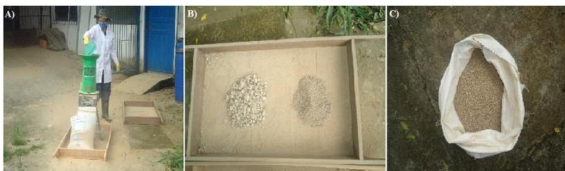
Figura 9. Moagem do lodo caleado. A) Trituração dos torrões de lodo; B) Subproduto antes e depois da moagem; e C) subproduto ensacado.
