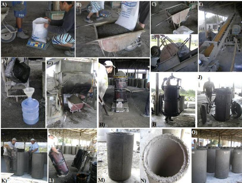
Figura 18. Fabricação experimental de tubos de concreto. A, B e C) Pesagem dos materiais; D e E) Transferência dos materiais para a esteira e betoneira. F) Dosagem da água; G) Transferência da betoneira para o molde; H) Adensamento do concreto; I, J e K) Transporte e desmolde; L) Lubrificação do molde; M, N e O) Tubo de concreto.
