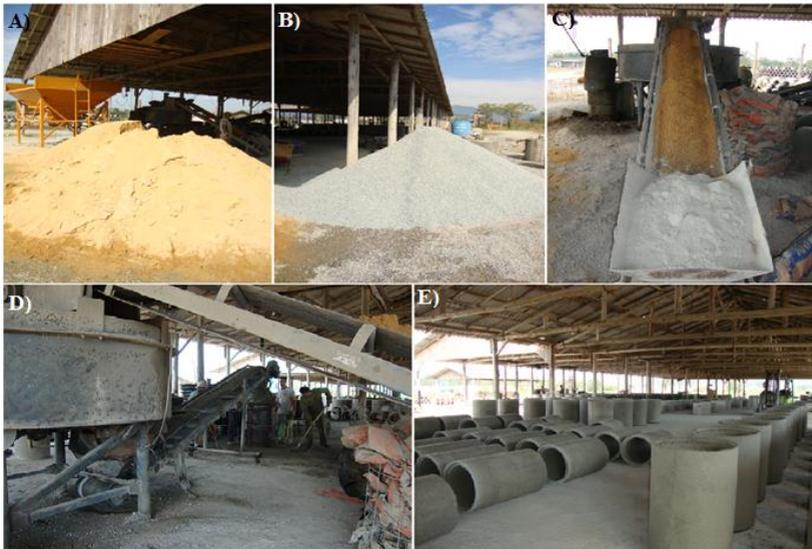
Figura 13. Processo de fabricação de tubos de concreto. A) Estoque de areia grossa; B) Estoque de brita nº 0; C) Colocação dos materiais na esteira; D) Adensamento da massas; E) Cura dos tubos produzidos.
