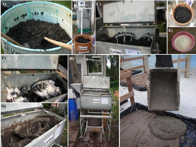
Figura 8. Processo de caleação. A) Recipiente de armazenamento; B) Balança; e C) Misturador de eixo horizontal; D) Recipiente com lodo de esgoto *in natura*; E) Recipiente com cal virgem; F) Misturador antes da homogeneização; G) Misturador depois da homogeneização; H) Retirada e transferência do material; e I) Acondicionamento do material na caixa de armazenamento.
