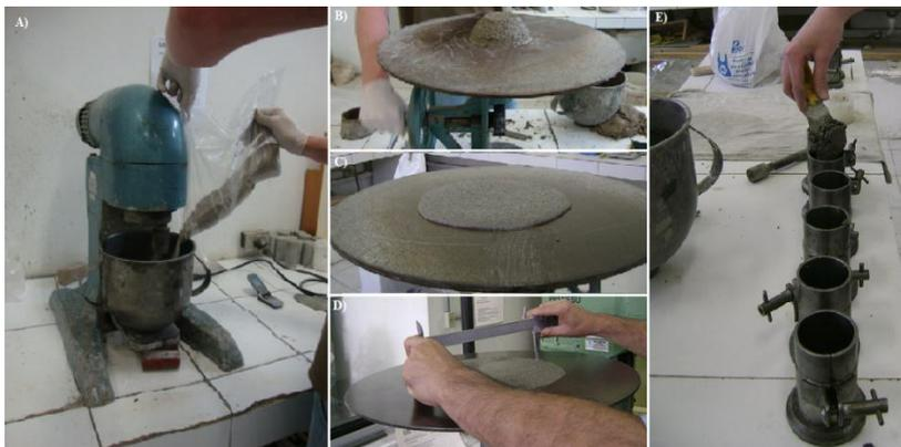
Figura 11. Determinação do IAP. A) Colocação dos materiais na argamassadeira; B, C e D) Realização do *Flow Test*; E) Moldagem dos CPs.
