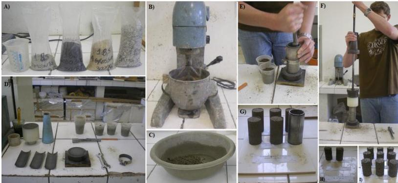
Figura 16. Imagens da moldagem dos CPs. A) Porções dos materiais que compõem o concreto; B) Argamassadeira utilizada para a homogeneização da mistura; C) Massa produzida; D) Equipamentos utilizados para a moldagem; E) Compactação da primeira camada do CP; F) Compactação da terceira camada do CP; G, H e I) Desmolde dos CPs produzidos.
