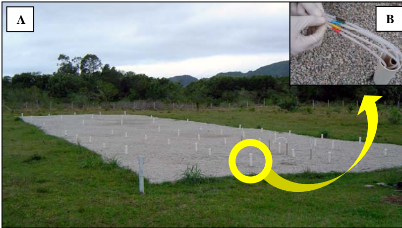
Figura 3.1 – Exemplo de uma área experimental (A) e ampliação de um poço de monitoramento cujas mangueiras identificadas com cores diferenciam cada nível de amostragem (B).
