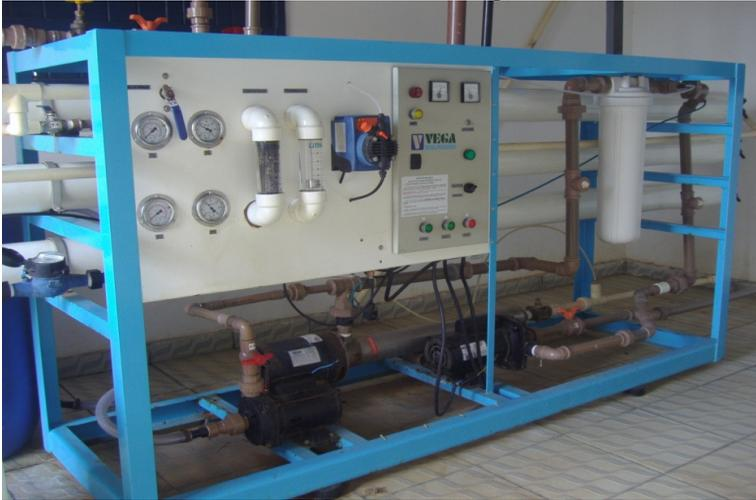
Uma grande vantagem dessa tecnologia por osmose reversa é a remoção de micro-organismos, pois o processo de separação física por membrana permite instantaneamente a retenção de bactérias, vírus, pirogênicos e muitas das matérias orgânicas e coloidais presentes na água (ARAÚJO et al., 2005).
