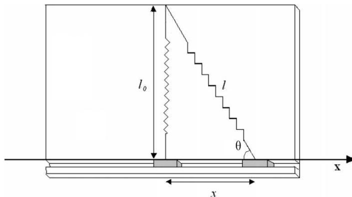
Figura 2.1: Diagrama do oscilador  $x^3$
